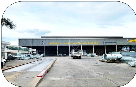
Hệ thống cân xe 80 tấn 80 tons vehicle weighing
